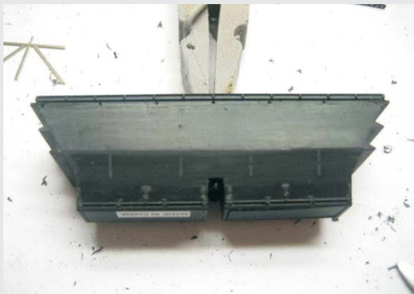
Tolva totalmente lijada y lista para recibir las piezas de fotografado
